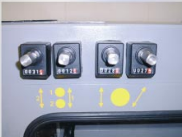
Alle Achsen sind horizontal und vertikal verstellbar. Ablesung über mechanische Positionsanzeigen.
