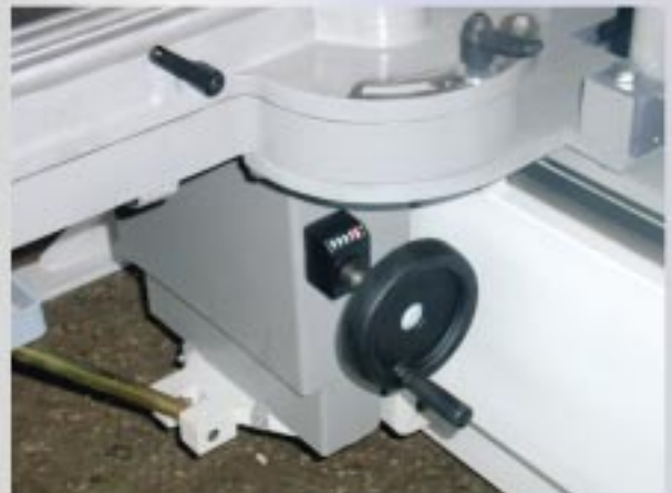
Vertikale Einstellung des Tisches durch einen mechanischen Positionsmesser.
