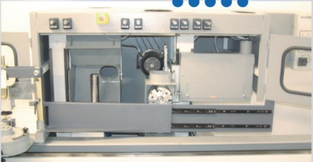
Easy access to each spindle through opening safety doors. Bei geöffneten Türen ist ein schneller und einfacher Zugang zu den Aggregaten möglich.
